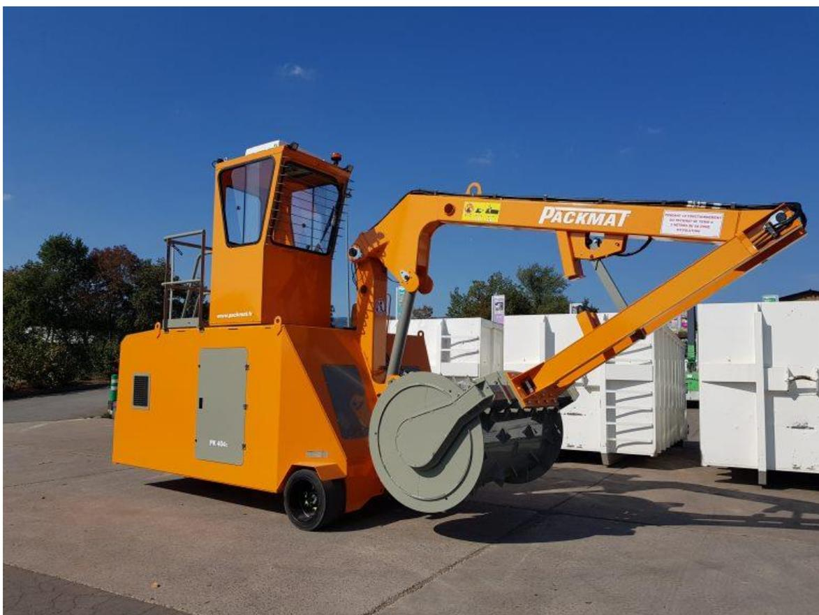
Cet équipement est capable de se déplacer de benne en benne et d'en compacter le contenu à l'aide d'un rouleau compacteur d'une masse de 2,3 tonnes.
